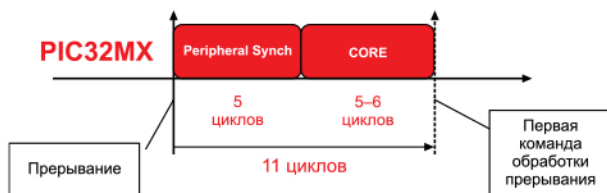
Рис. 4. Обработка высокоприоритетного прерывания в PIC32MX
