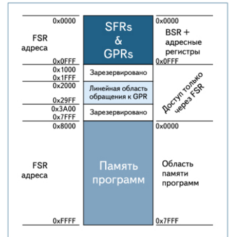
Рис. 3. Организация памяти новых контроллеров. Области адресации памяти данных, программ и доступ при косвенной адресации
