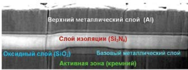
Рис. 1. Зона эмиттера транзистора BISS в разрезе
