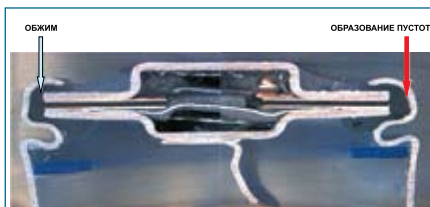
Рис. 4. Конструкция LiSOC12 батареи большинства производителей
