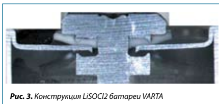
Рис. 3. Конструкция LiSOC12 батареи VARTA
